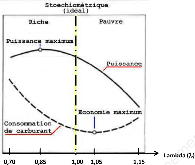
**3.10** Lors d'un déplacement, on peut décomposer le mouvement d'un véhicule en phases de deux types : la phase d'accélération et la phase de roulage à vitesse constante. Indiquer l'intervalle des valeurs du coefficient d'air correspondant à la phase d'accélération puis celui correspondant à la phase de roulage à vitesse constante pour obtenir un fonctionnement optimal du véhicule.
