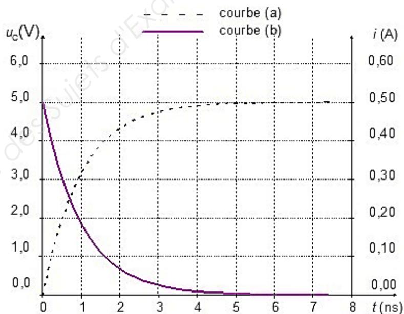
**2.1.1** En exploitant le **document 7**, indiquer, en justifiant qualitativement votre réponse, quelle est la courbe (a) ou (b) qui correspond à la tension  $u_c$  et celle qui correspond à l'intensité  $i$  du courant dans le circuit.
