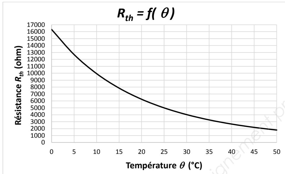
**1.8** En utilisant les **documents 2 et 3**, déterminer le coefficient de température  $\alpha_{298}$  à la température de 298 K ( $\theta = 25\text{ °C}$ ) et l'indice de sensibilité B caractéristiques de la thermistance utilisée pour réaliser la sonde de température NTC M12.
